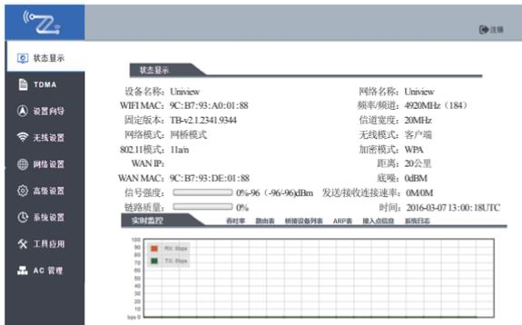
步骤4 点击“设置向导”菜单。该向导帮助用户快速配置设备，如网络配置，无线模式等。设备缺省配置为“网桥模式”，LAN口IP地址为“192.168.1.36”。建议修改LAN IP。
