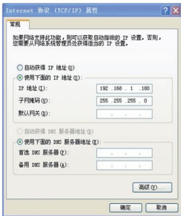
步骤2 在PC浏览器输入设备缺省的IP地址192.168.1.36，系统显示登录页面；
